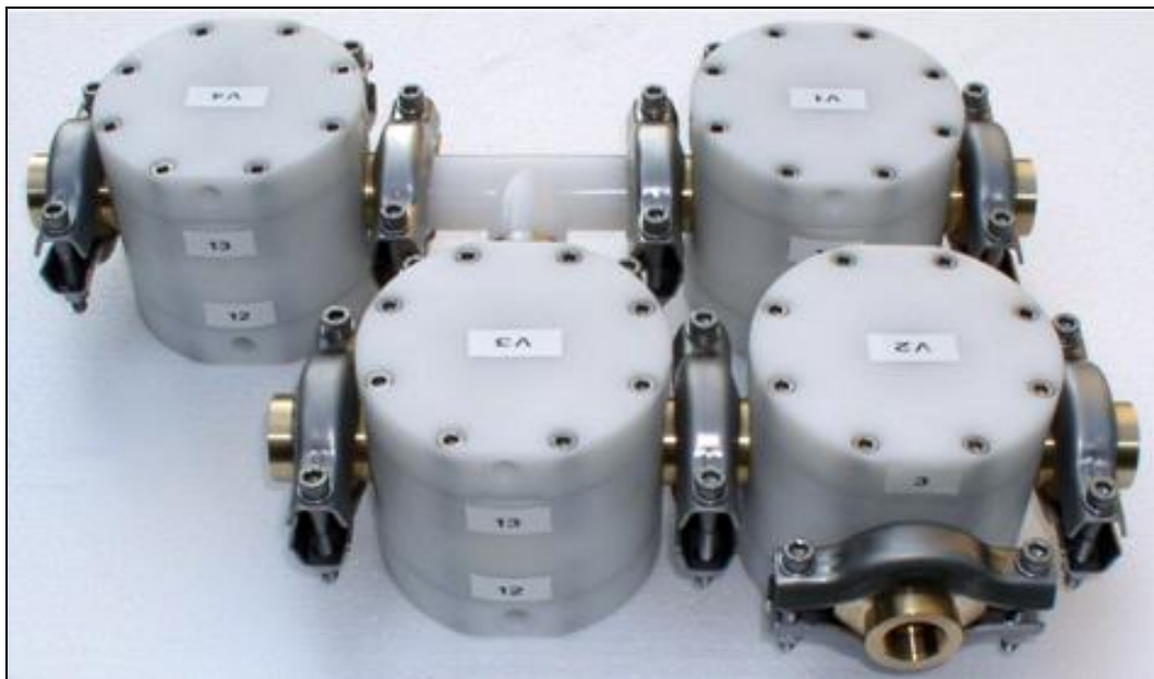
FIGURA 1 - ESEMPIO DI ISOLA DI VALVOLE PER LA GESTIONE DI UN COLORE IN UNA MACCHINA DA STAMPA
